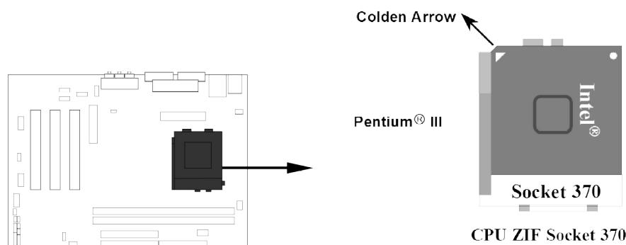
當你將CPU插入ZIF插槽時，不要使用太大的力量，插入後只要輕輕把拉桿沿正確方向按下即可。
