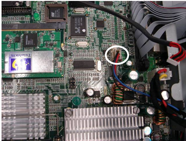
g. Disconnect the fan cable (1).
