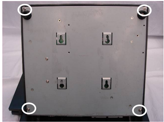
f. Remove the screws (4).
