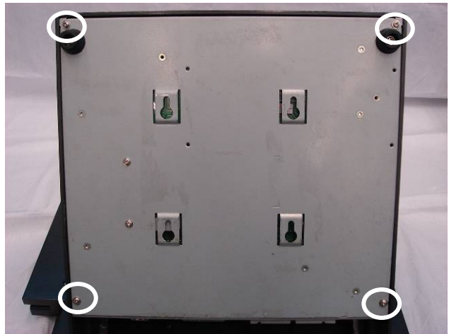
f. Remove the screws (4).
