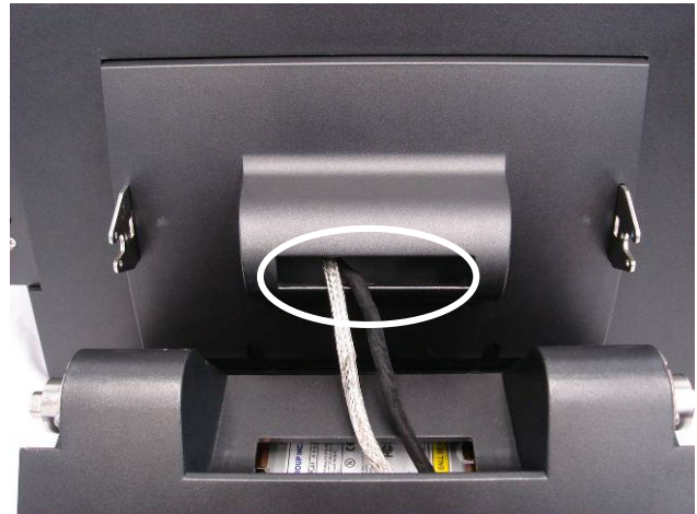
d. Disconnect the cables (2).
