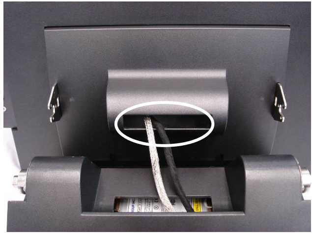
d. Disconnect the cables (2).
