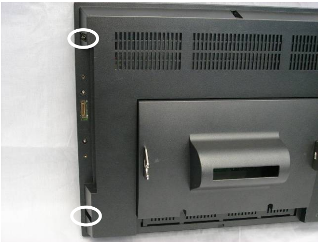
k. Remove the screws (2).
