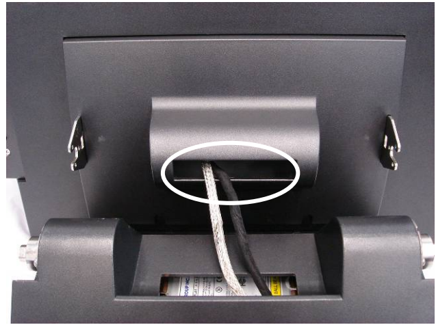
d. Disconnect the cables (2).
