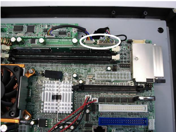
g. Disconnect the cables (2).
