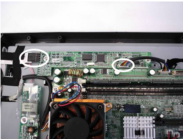
a. Disconnect the cables (2).
