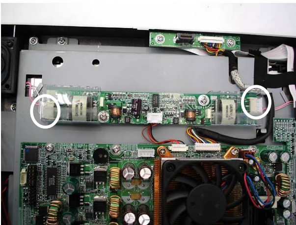
a. Disconnect the cables (2).
