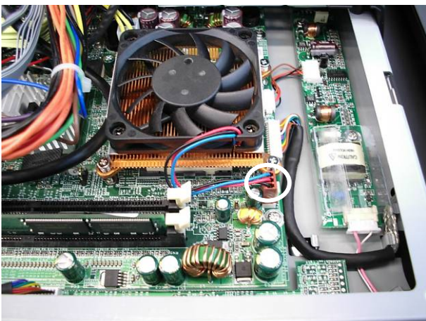
e. Disconnect the fan cable.
