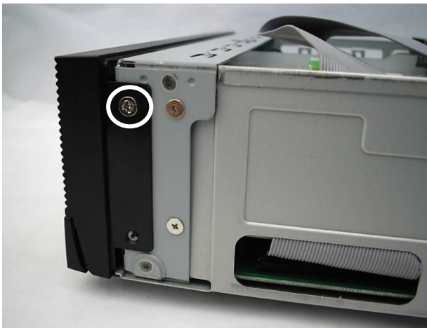
a. Remove the screw (1).
