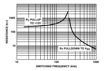
FIGURE 1. RT RESISTANCE vs FREQUENCY
