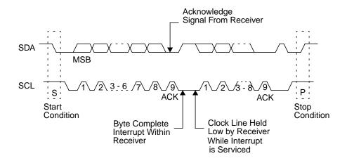
Figure 24. ACCESS.bus Data Transaction
