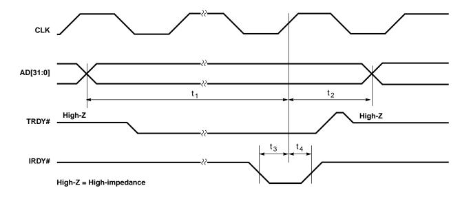
Figure 11-4. Ready Data/TRDY# (PCI Bus)
